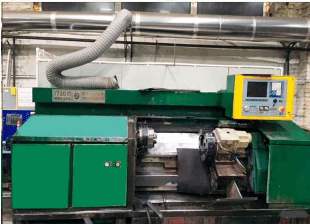
токарний патронно-центровий верстат з ЧПК мод. 1720ПФ30
