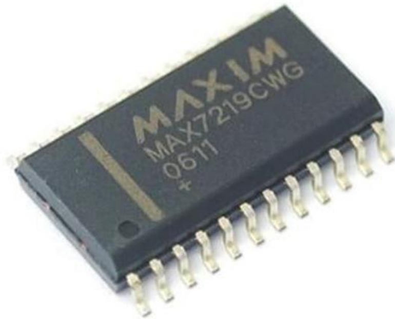
Рисунок 3.5 — Мікросхема MAX7219 в SMD корпусі.
