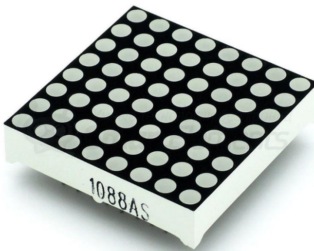
Рисунок 3.4 — Led матриця 8 на 8 модель 1088AS.
