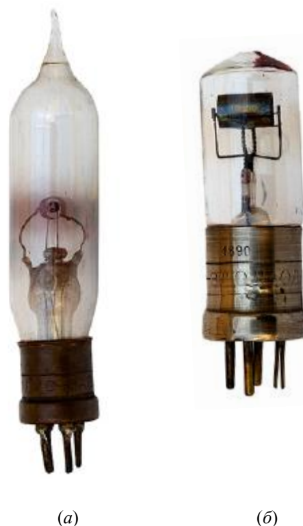
Рис. 2. Электровакуумные триоды производства Одесского радиозавода (1922 г.). Габариты ламп, мм: (а) D = 35 , l = 190 ; (б) D = 30 , l = 100 [7]
