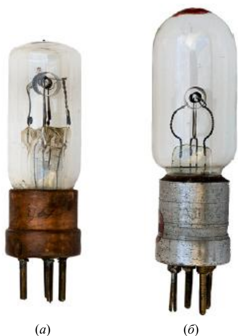
Рис. 3. Электровакуумные триоды производства Одесского радиозавода (1922 г. и 1923 г.). Габариты ламп, мм: (а) D = 30 , l = 105 ; (б) D = 35 , l = 130 [7]
