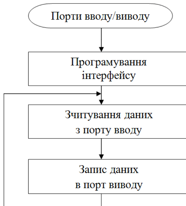
Рис. 2. Структурна схема програми для перепису даних з порту введення в порт виводу
