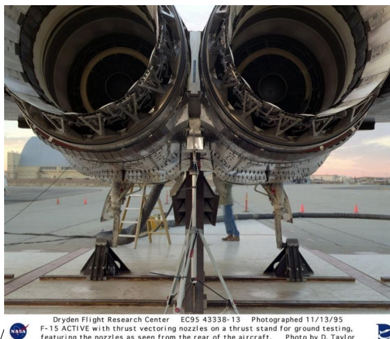
Рис. 1.15. F-15B ACTIVE із соплами, керованими вектором тяги, на випробувальному стенді [26]
