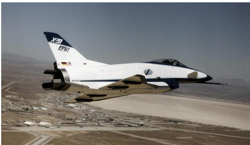
Рис. 1.4. Експериментальний літак Х-31, призначений для дослідження керування вектором тяги та післязривної маневреності [10]
