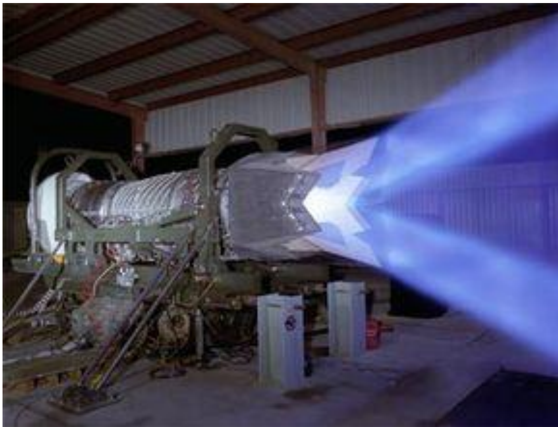
Рис. 1.14. Відхилення реактивного струменя двигуна F-22 Raptor у вертикальній площині [24]
