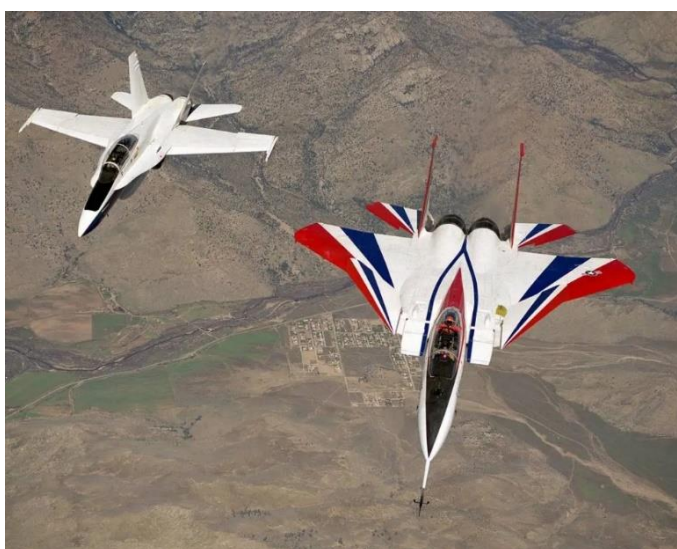
Рис. 1.5. Літак F-15B ACTIVE під час випробувань системи керування вектором тяги [11]
