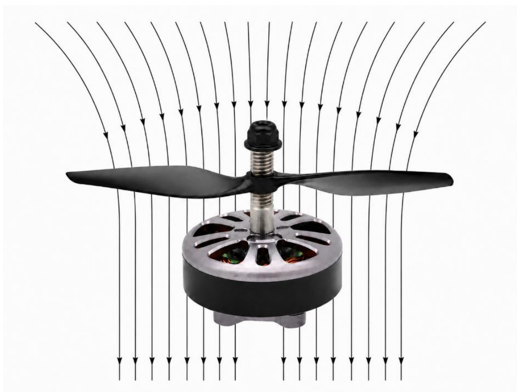
Рис. 2.1. Напрямок повітряного потоку через пропелер електродвигуна
