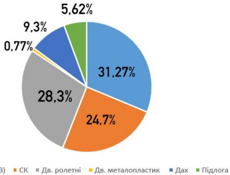
Рисунок 3.10 – Теплові втрати крізь огорожувальні конструкції
