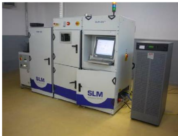
Рисунок 1.7 – Установка SLM 250HL (SLM Solutions, Німеччина) [32]
