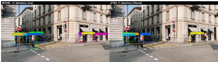
Рисунок 4.2 — Порівняння детекцій до та після фільтрації на окремому кадрі
