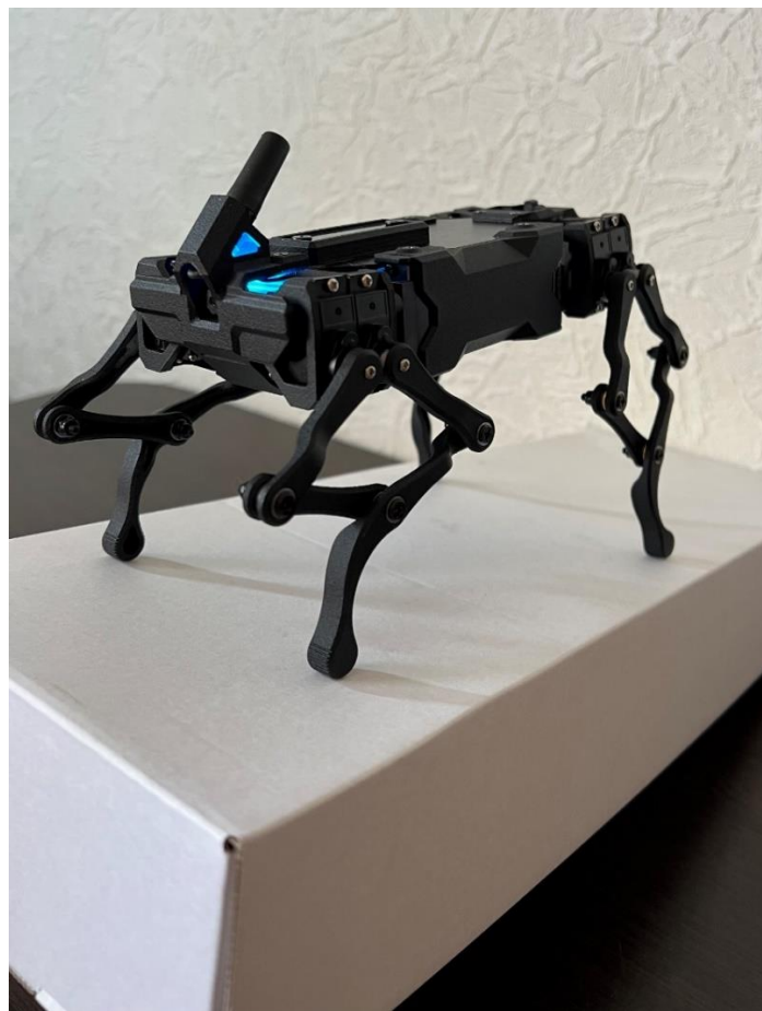
Рисунок 5.8. – перший приклад роботи режиму автоматичної стабілізації платформи крокуючого робота (вид збоку)
