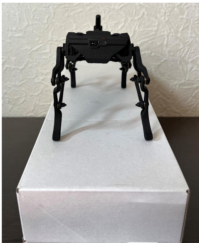
Рисунок 5.10. – другий приклад роботи режиму автоматичної стабілізації платформи крокуючого робота (вид ззаду)
