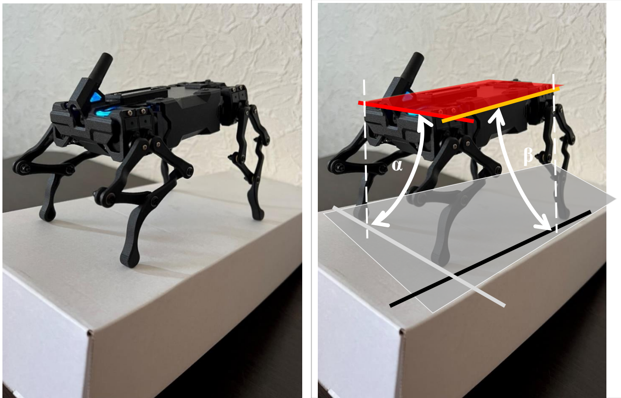
Рисунок 5.9. – другий приклад роботи режиму автоматичної стабілізації платформи крокуючого робота (ізометричний вид)
