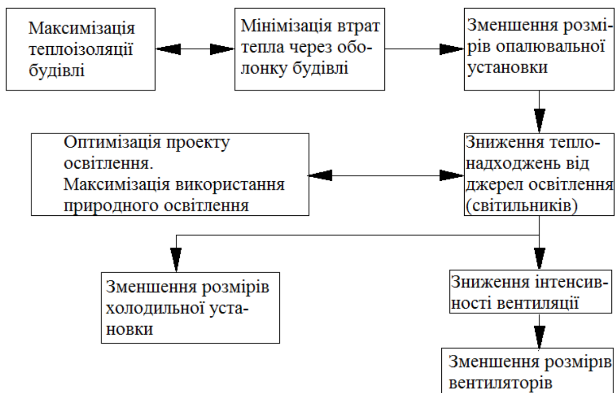
Рис. 1.6 – Схема взаємозалежності основних енергозберігаючі заходів будинку як єдиної теплоенергетичної системи [39]
