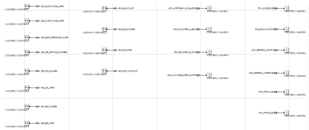
Рисунок 3.2.11 – Фізичні виходи та входи в РСМ600
