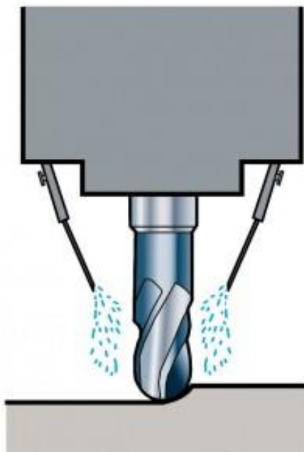
Рис.1.10. – Схема подачі ЗОР у вигляді масляного туману.
