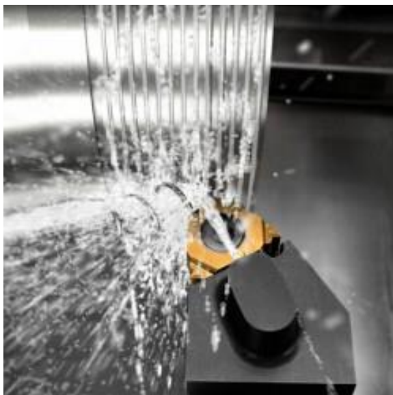
Рис.1.12. Схема високоточного підводу ЗОР при точінні різьби
