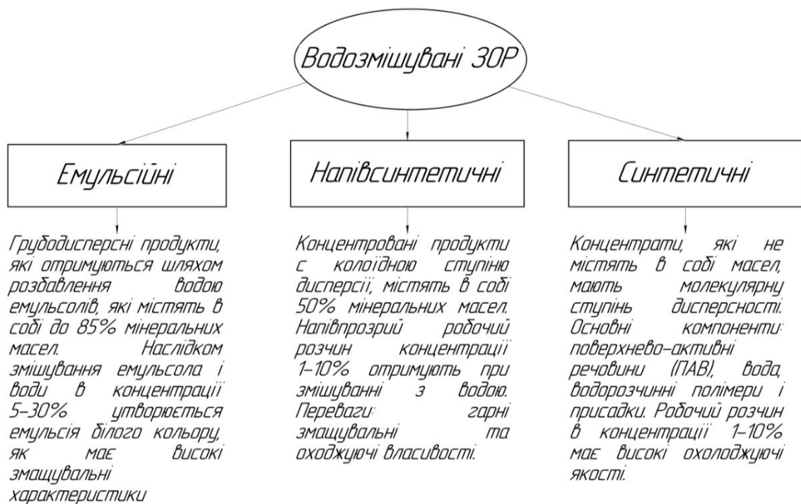
Рис.1.2. Види водозмішуваних ЗОР
