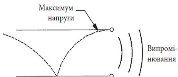
Рисунок 14.4 — Випромінювання хвиль розімкнутою лінією передачі
