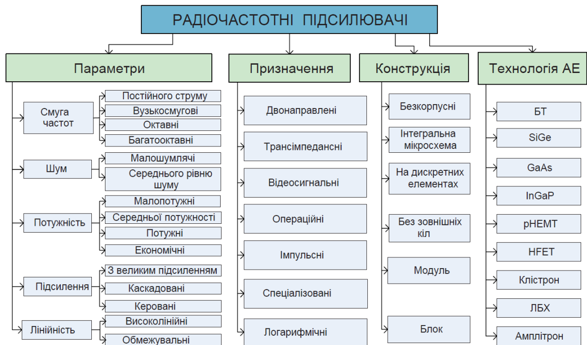
Рисунок 10.2 — Класифікація радіочастотних підсилювачів
