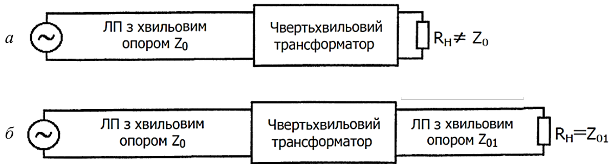
Рисунок 4.2 — Узгодження лінії передачі за допомогою чвертьхвильового трансформатора з іншою лінією з активним опором (а) та з іншою лінією (б)
