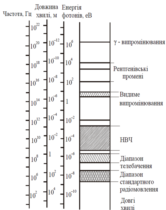
Рисунок 1.1 — Шкала частот електромагнітного випромінювання
