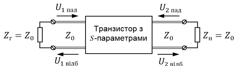
Рисунок 11.1 — Структурна схема НВЧ транзистора в лінії передачі
