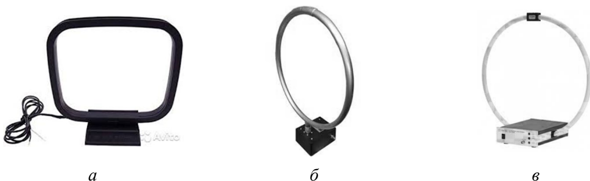
Рисунок 14.9 — Варіанти конструкції рамкової антени: а) прямокутна; б) кругла; в) кругла активна
