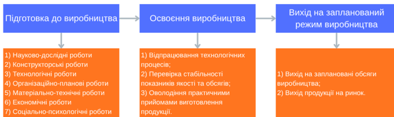
Рисунок 1.1 – Етапи та порядок робіт з організації виробництва нової продукції на підприємстві
