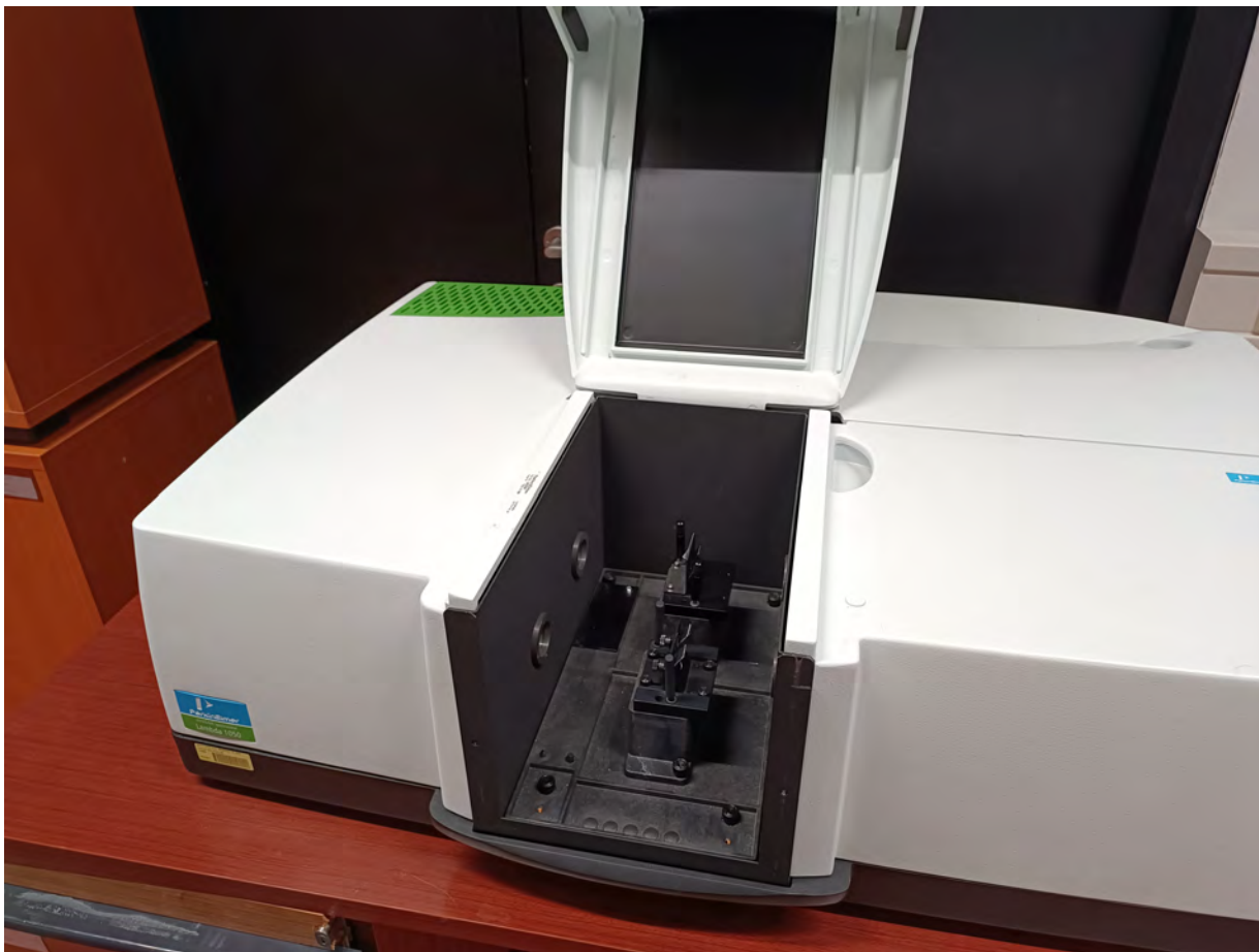
Рис. 2.17. Внутрішня частина PerkinElmer Lambda 1050. Кювета із зіфіксованим полімером
