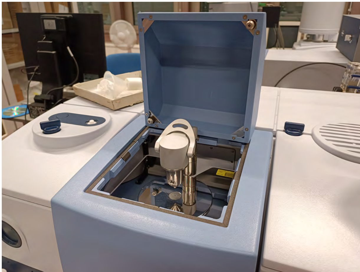
Рис. 2.20. Bruker VERTEX 80. Кювета із зіфікованим полімером
