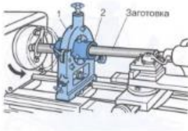
Рис. 16. Застосування люнетної втулки.
