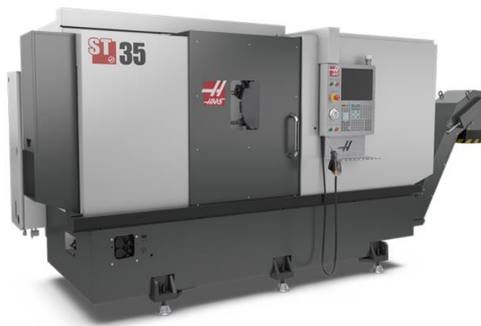
Рис. 2.7. Токарно-револьверний обробляючий центр з ЧПУ HAAS ST-35
