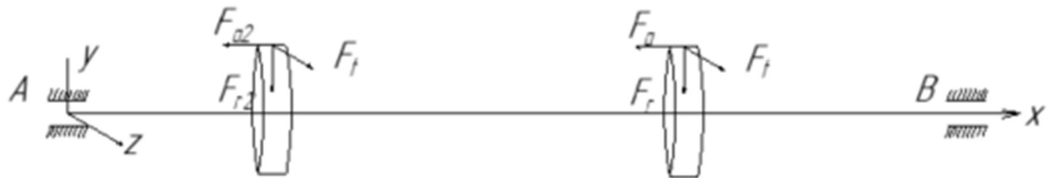
Рис 3.1 Розрахункова схема вала
