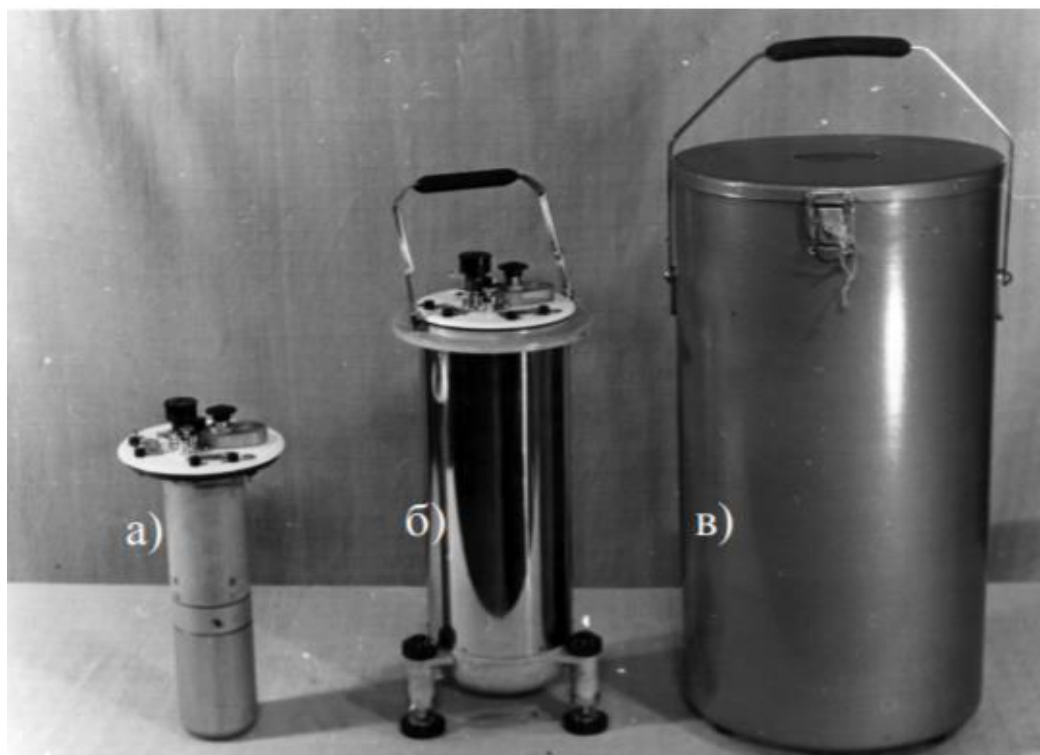
Рисунок 3.2 - Гравіметр: а) внутрішня частина приладу; б) загальний вигляд приладу; в) транспортувальний футляр циліндричної форми, виготовлений з жерсті
