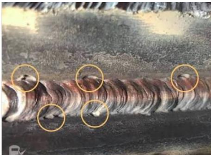
Рисунок 1.7 – Підрізи уздовж країв зварного шва
