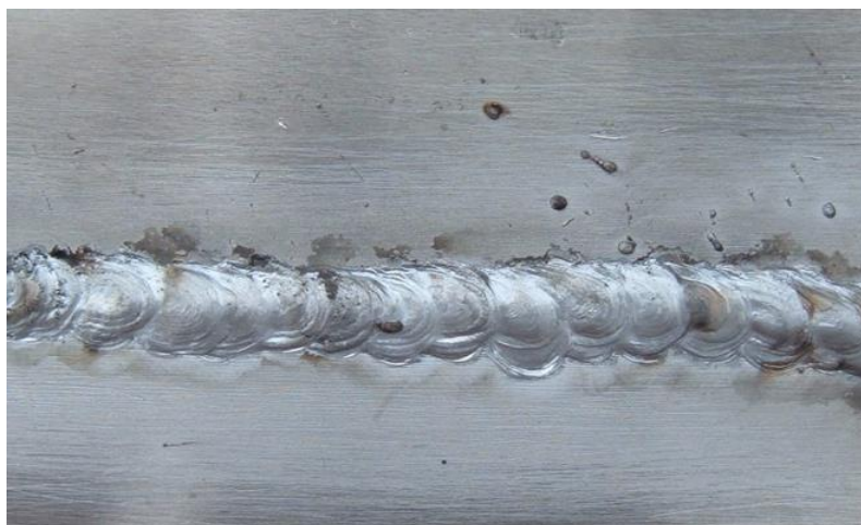
Рисунок 1.9 – Незадовільне формування шва з алюмінієвого сплаву
