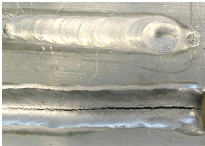
Рисунок 1.6 – Гаряча тріщина у зварному шві з алюмінієвого сплаву
