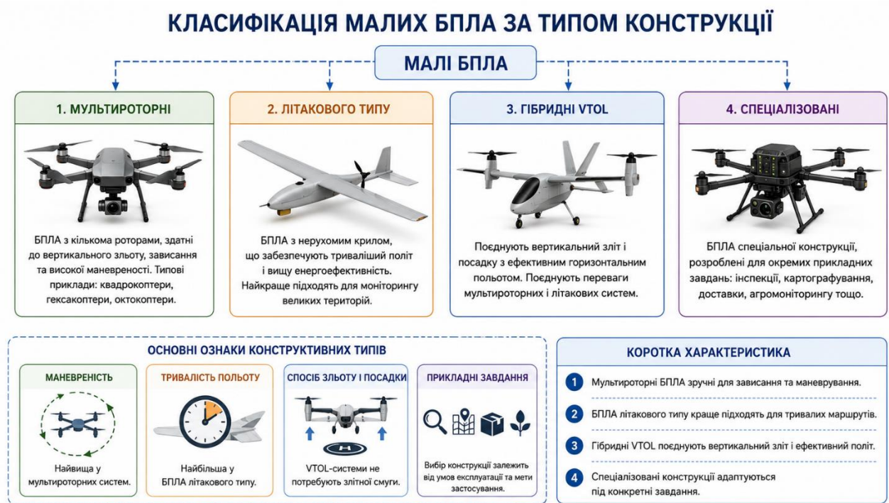
Рис. 1.2. Класифікація малих БПЛА за типом конструкції
