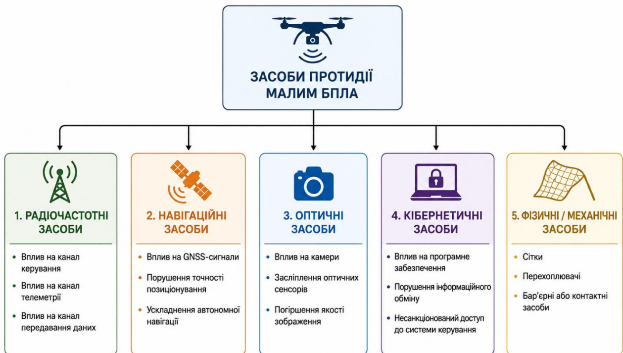
Рис. 1.8. Основні групи засобів протидії малим БПЛА
