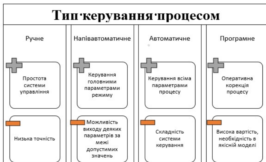
Рис.1.5. Класифікація установок хіміко-термічної обробки азотування в тліючому розряді за типом керування процесом
