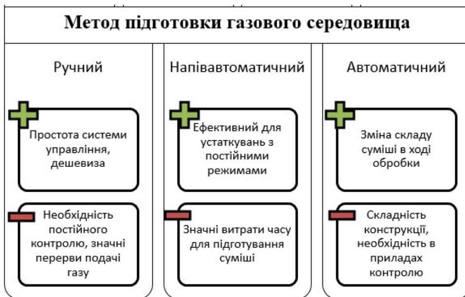
Рис.1.6. Класифікація установок хіміко-термічної обробки азотування в тліючому розряді за методом підготовки газового середовища.
