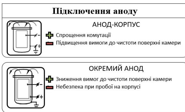
Рис.1.9. Способи підключення аноду в системах установок хіміко-термічної обробки азотування в тліючому розряді
