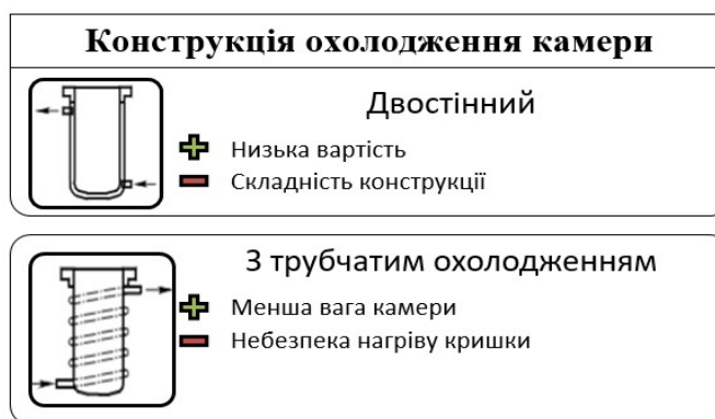
Рис.1.10. Способи охолодження камер в системах установок хіміко-термічної обробки азотування в тліючому розряді
