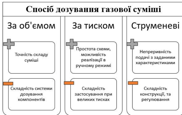
Рис.1.7. Класифікація установок за способом підготовки газового середовища.
