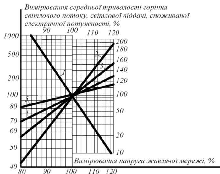
Рисунок 5.2 – Залежність світлотехнічних, електричних і експлуатаційних параметрів ламп розжарювання загального призначення від зміни напруги мережі живлення: 1 – середній ресурс експлуатації; 2 – світловий потік; 3 – світлова віддача; 4 – споживана потужність; 5 – сила струму.
