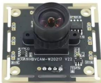
Рис 2.9 — USB камера з матрицею OV9732
