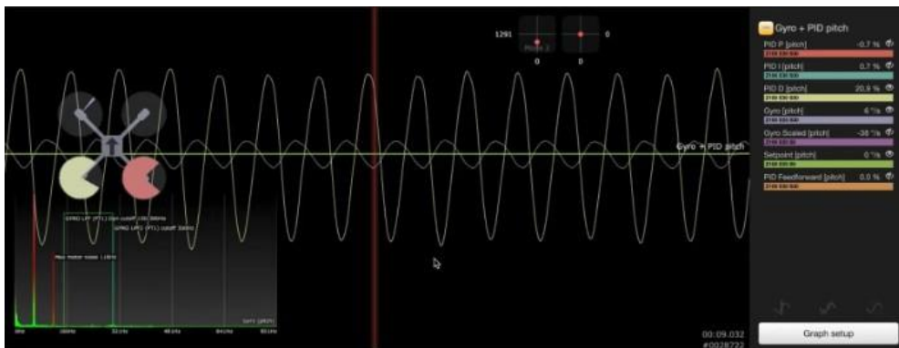
Рис 2.13 - Поведінка дрона при великому значенні коефіцієнта D складової
