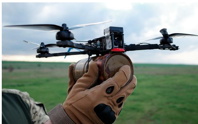
Рис. 2.1 — FPV дрон з боєприпасом
