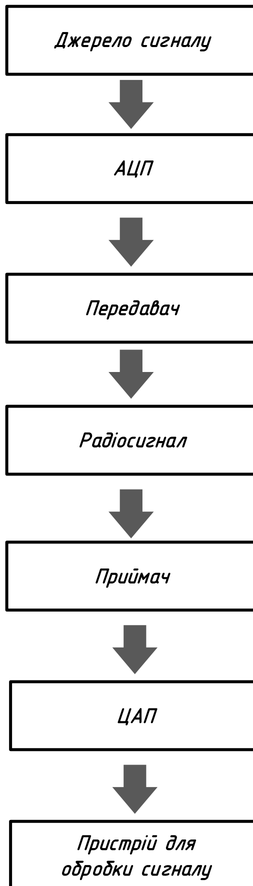
Рисунок 1.3 — Загальна схема передавання сигналу цифровим способом
