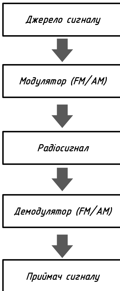
Рисунок 1.2 — Загальна схема бездротового передавання аналогового сигналу.
