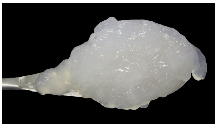
Рисунок 2.3 – Зображення водної суспензії наноцелюлози, попередньо обробленої ферментативно [12]
