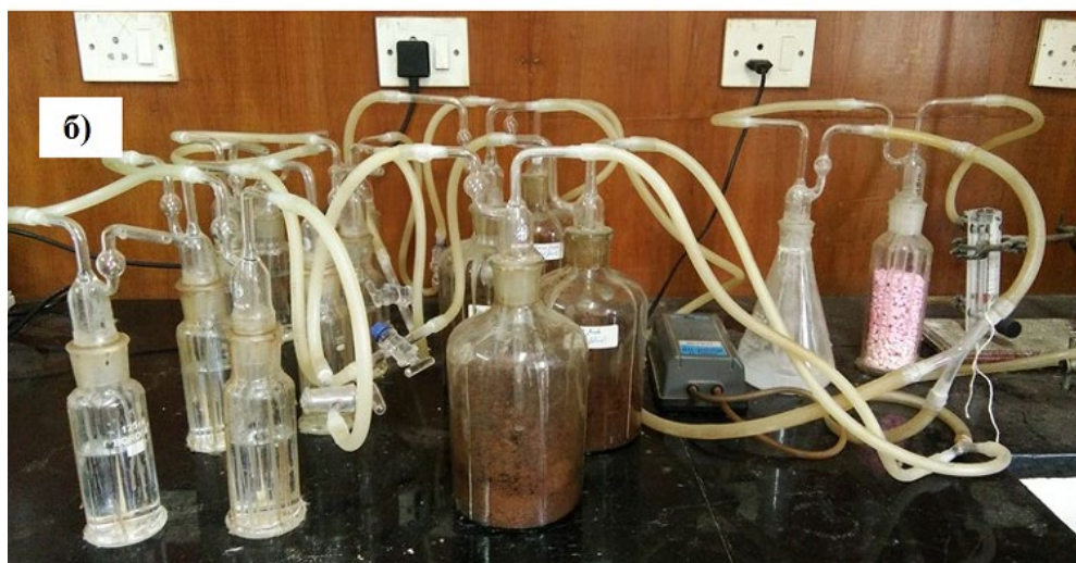
Рисунок 2.12 – Вимірювання кількості вуглекислого газу, що виділився під час біодеградації: а – принципова схема; б – зовнішній вигляд установки [34]
