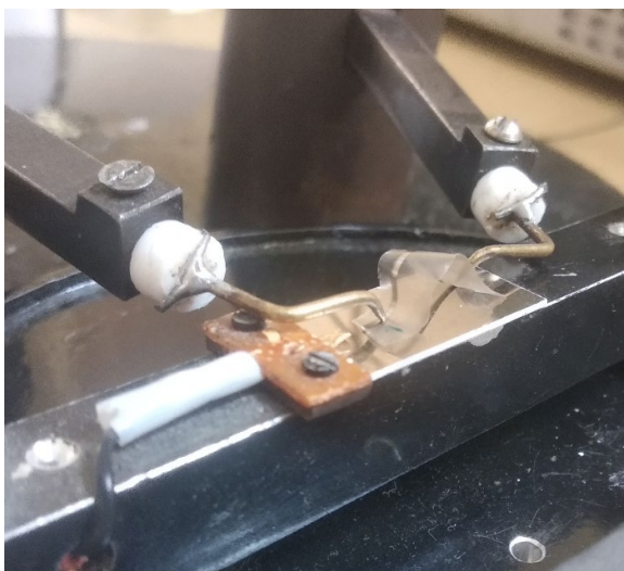
Рисунок 4.7 – Дослідна установка для зняття ВАХ структур Ni/НЦ у зігнутому стані
