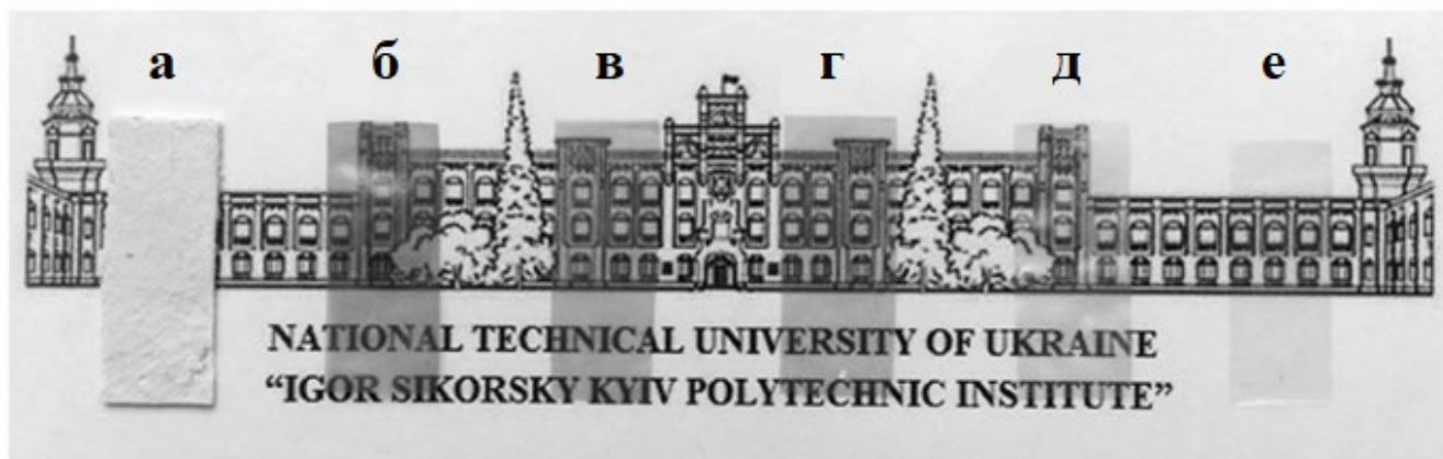
Рисунок 2.9 – Зовнішній вигляд CNF: а – смужка CNF перед обробкою; б – CNF після ультразвукової обробки. Плівки CNF, приготовані після гідролізу сірчаної кислоти концентрацією 43% при: в – 20 °С, 30 хв; г – 20 °С, 60 хв; д – 60 °С, 30 хв; е – 60 °С, 60 хв [22]
