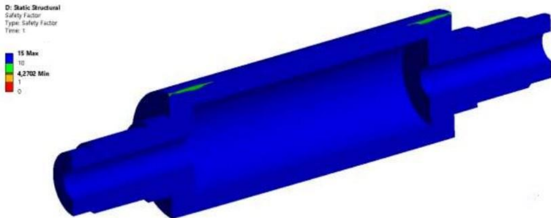
Рисунок 7.8 – Поле запасу міцності числової моделі модернізованого валка каландра за патентом № UA120214U
