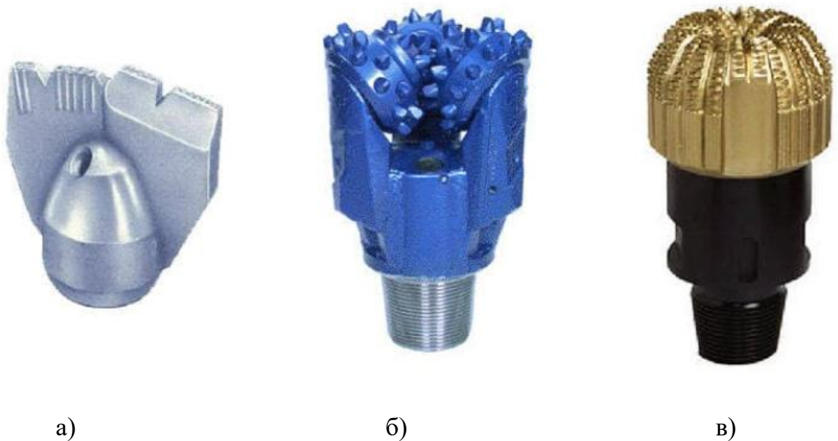
Рисунок 1.1 – Варіанти конструкцій типів бурових головок[1] (а-лопатне долото, б-шарошечне долото, в- секторне(алмазне) долото)
