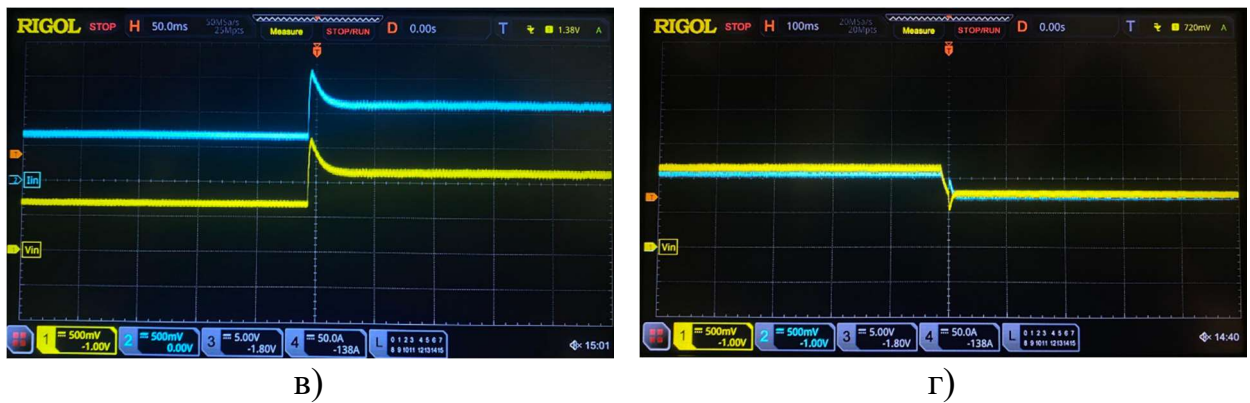
Рис. 4.40. Осцилограми роботи двох PIPO перетворювачів при балансуванні струму: (а), (б) – вихідна напруга; (в), (г) – вихідні струми перетворювачів.
