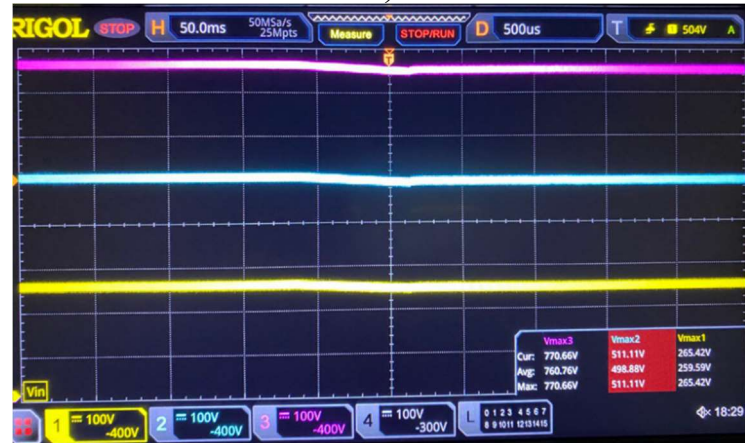
Рис. 4.41. Осцилограми роботи 3 SIPO перетворювачів: (а) вхідна напруга перетворювачів при відсутності балансування; (б) вхідна напруга перетворювачів при наявності балансування й пуску системи; (в) вхідна напруга перетворювачів при зміні вихідної напруги з 10В до 24В.
