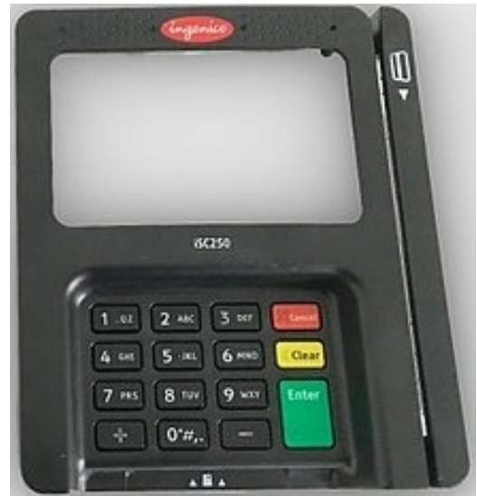
Рис. 5. Накладка на POS термінал
