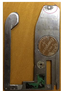
Рис. 3. Скімер, встановлюється у проріз
