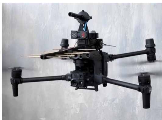
Рис 1.4.3 – БПЛА з використанням антени типу «хвильовий канал» в ролі ретранслятора
