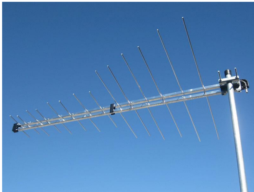
Рисунок 1.1.1 Логоперіодична вібраторна антенa, яка використовується для прийому телевізійних програм
