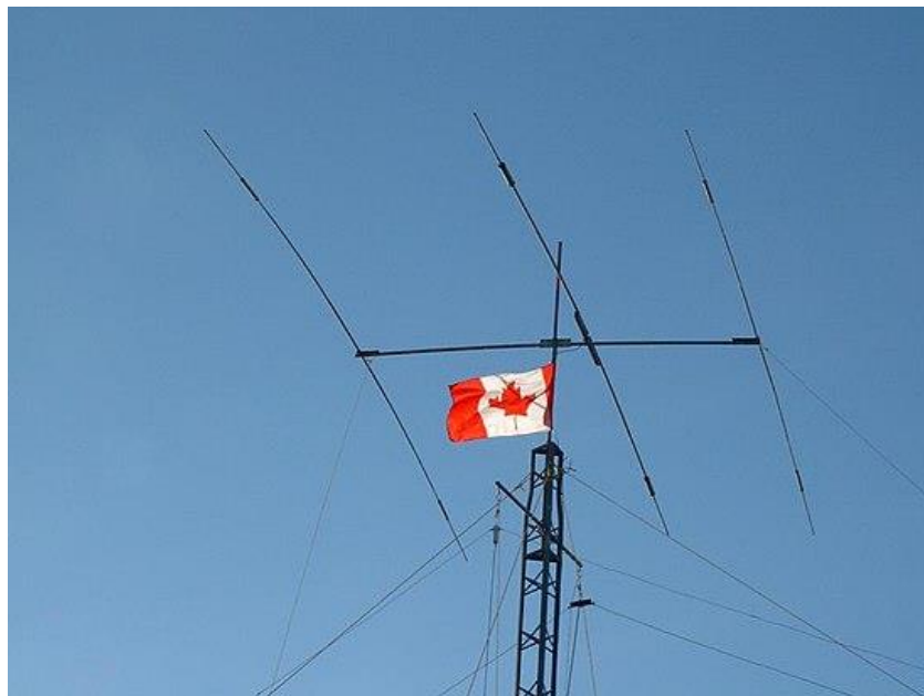
Рис 2.4.2 - Зліва направо на траверсі змонтовані рефлектор, активний вібратор і директор. Добре видно, що рефлектор трохи довший за активний вібратор, а директор коротший.
