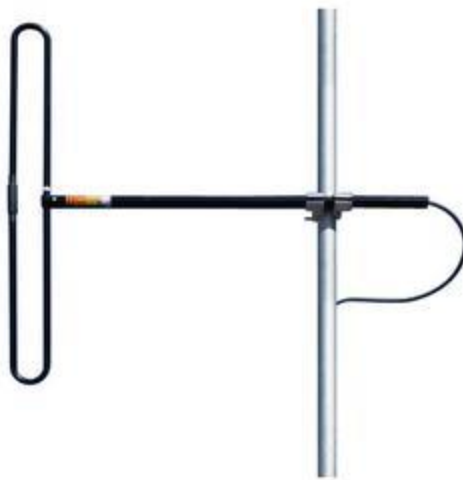
Рисунок 1.3.5 —Петльовий вібратор Пістолькорса
