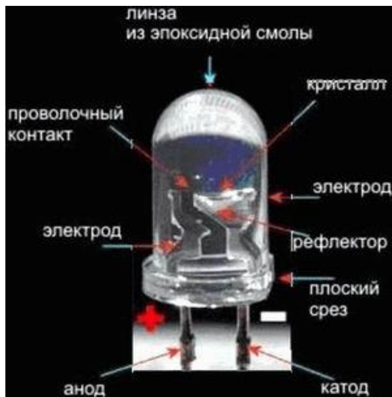
Рис.2.4. Загальний вигляд та будова діоду [26]
