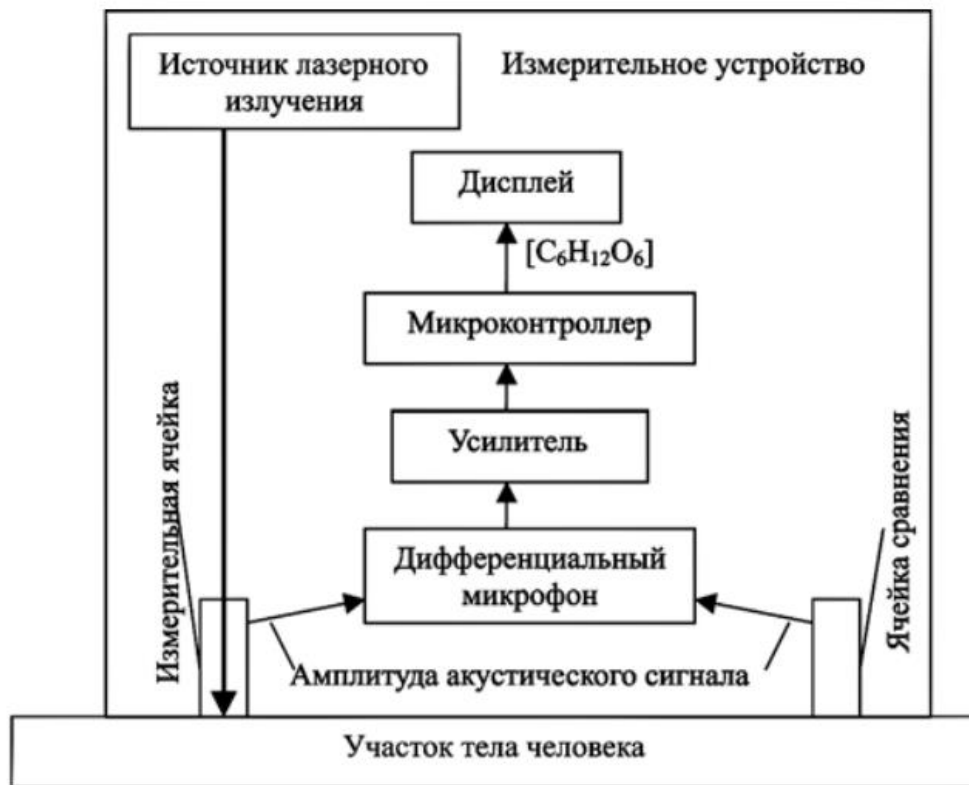
Рис.1.11 Блок-схема приладу для вимірювання рівня глюкози в крові за допомогою фотоакустичного методу [14]
