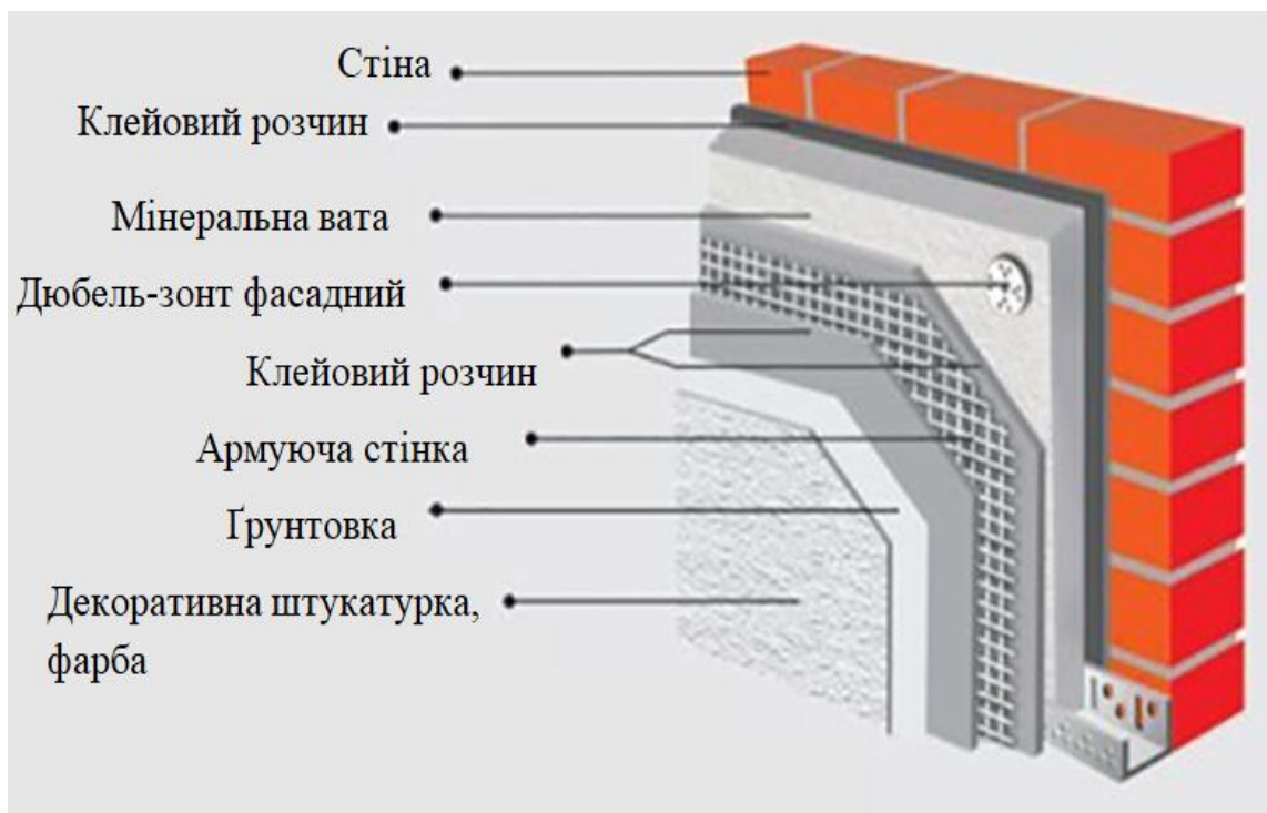
Рисунок 3.7 – Послідовність шарів утеплювача
