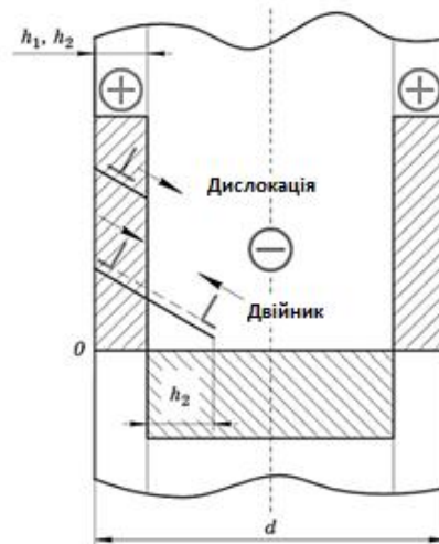
Рисунок 1.12 – Схема утворення дефектів і розподілу напруг по обсягу нанозразка, які утворюються в результаті дії сили поверхневого натягу: «+», «-» – розтягуючі і стискаючі напруження
