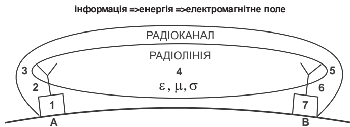
Рисунок 1.1. Спрощена схема організації радіозв'язку (РАДІОКАНАЛ)
