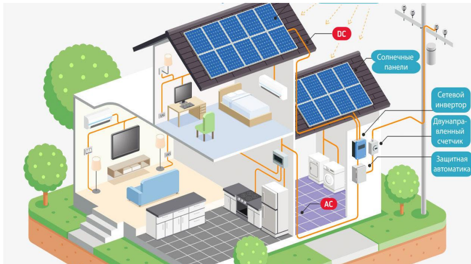
Рисунок 3.1- Приклад гібридної системи, для приватного будинку
