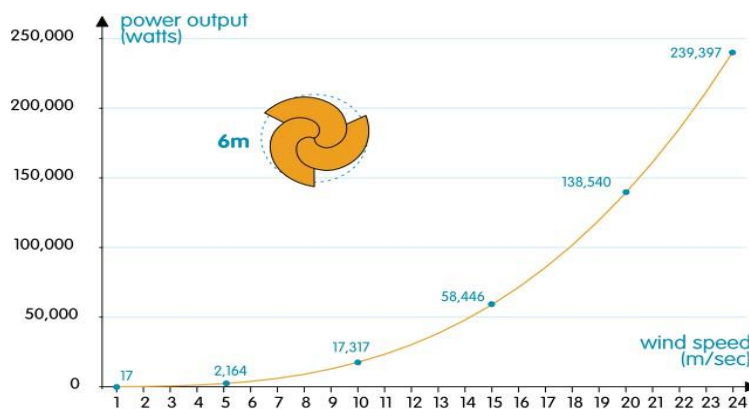
Рисунок 3.4 -Графік залежності потужностей від швидкості вітру
