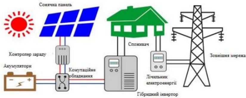
Рисунок 2.6 - Схема автономної, з'єднаної з мережею (гібридної) СЕС.
