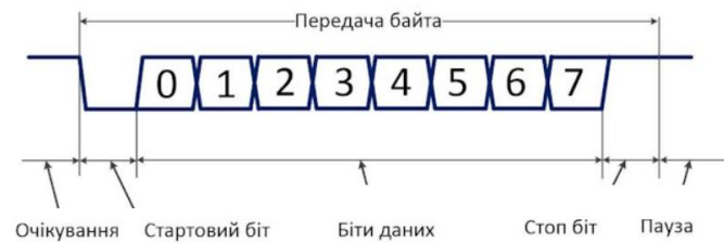
Рисунок 3.3 – Принцип дії протоколу UART
