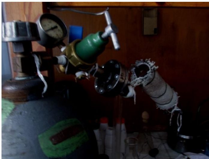
Рис. 2.4. Фото реактора синтезу гідразину під тиском 2,3 МПа
