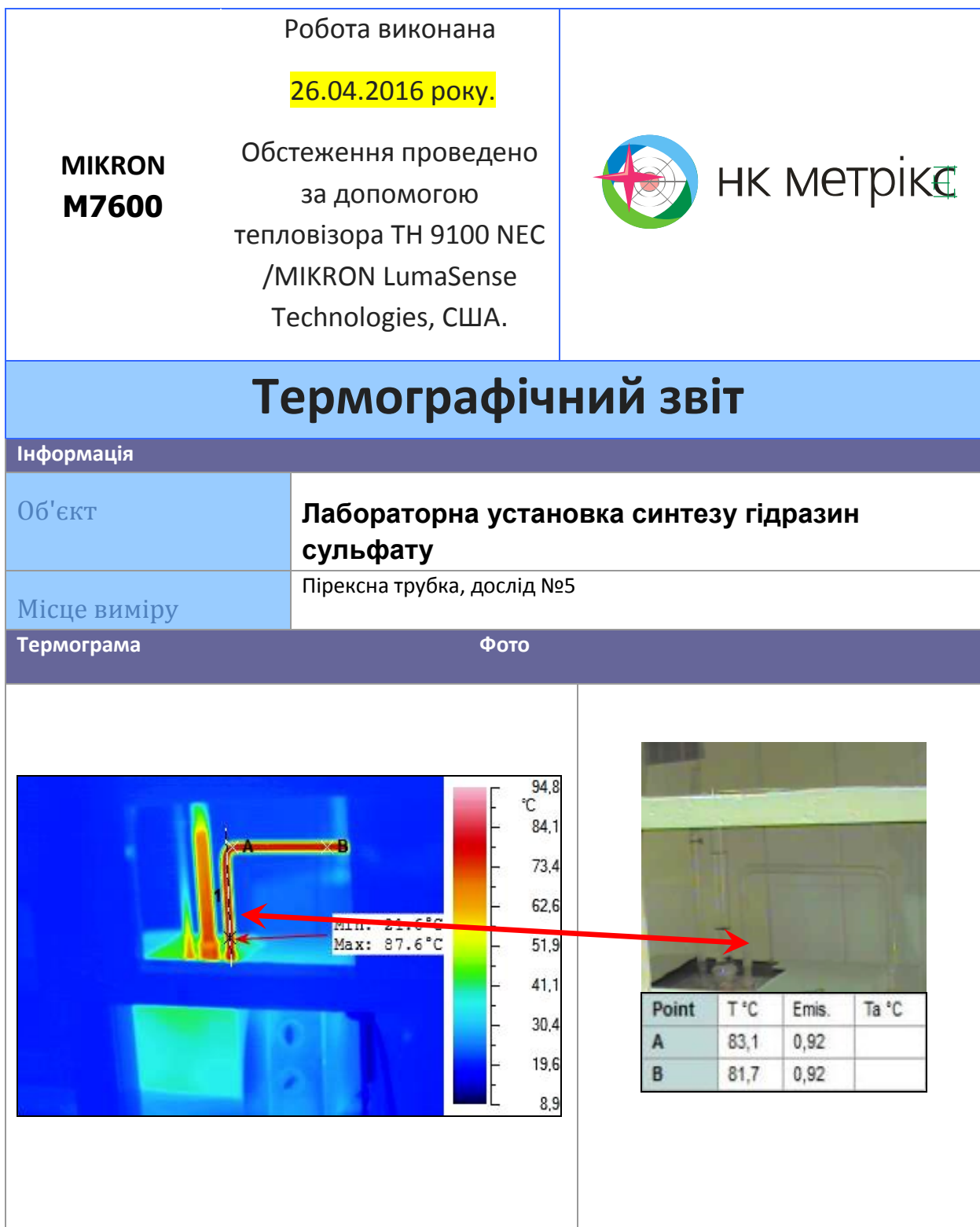
Рис. 2.7. Приклад термограми процесу синтезу гідразин-сирцю в бороселікатній лабораторній установці синтезу гідразин сульфату з використанням тепловізора TH 9100 NEC
