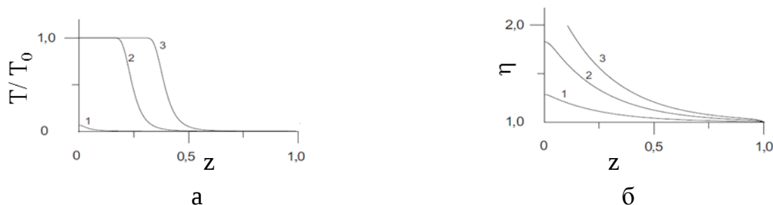
Рис. 5.2 Значення відношення температури T до T_0 хімічної реакції (а) та \eta (б) продукту реакції що протікає в зоні дії опромінення.
