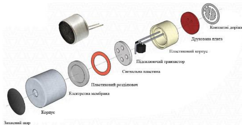
Рисунок 1.10. Будова електретного мікрофону
