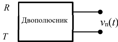
Рис. 6.5. Еквівалентний двополюсник при визначенні коефіцієнту шуму при наявності шумової напруги
