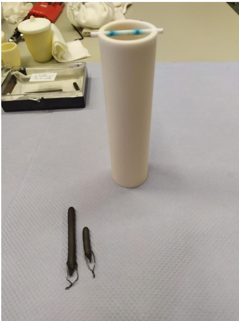
(рис.23 Приклад тигля для вертикального відпалювання. Жірdochка зверху використовується для закріплення на ній фідродів. Важливо зазначити, що
