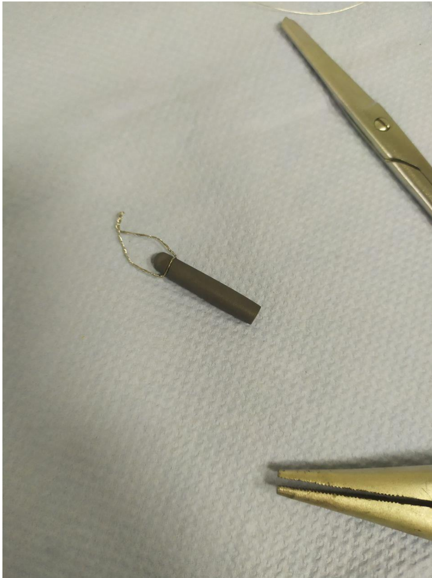
(рис.22 Стержень з відповідною горизонтальною боріздкою, ширина котрої, зазвичай, підбирається під діаметр проволочки, котру планується намотувати на нього)
