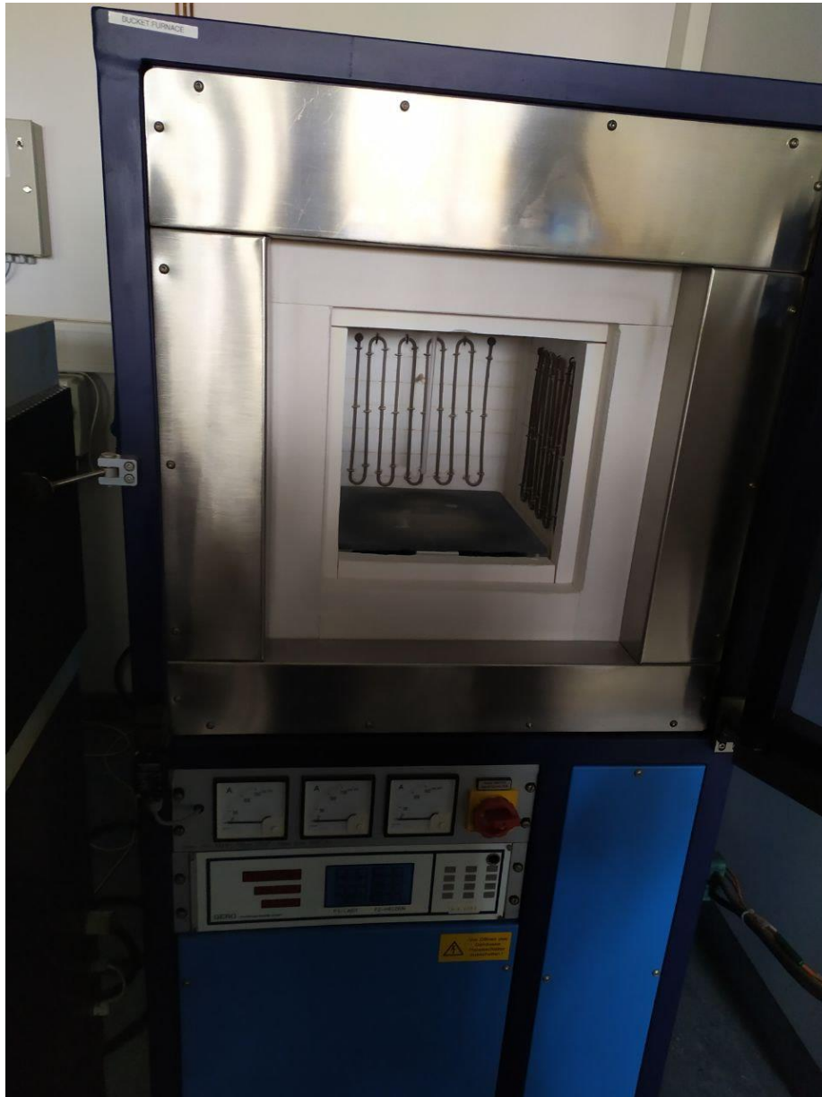
(рис.24 Вертикальна муфельна піч. Тигель зі зразками ставиться усередину, на спеціальну підставку)
