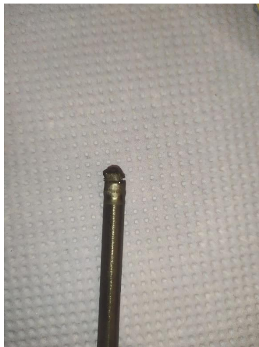
(рис.38 Вигляд неправильно припавленого розчинника)
