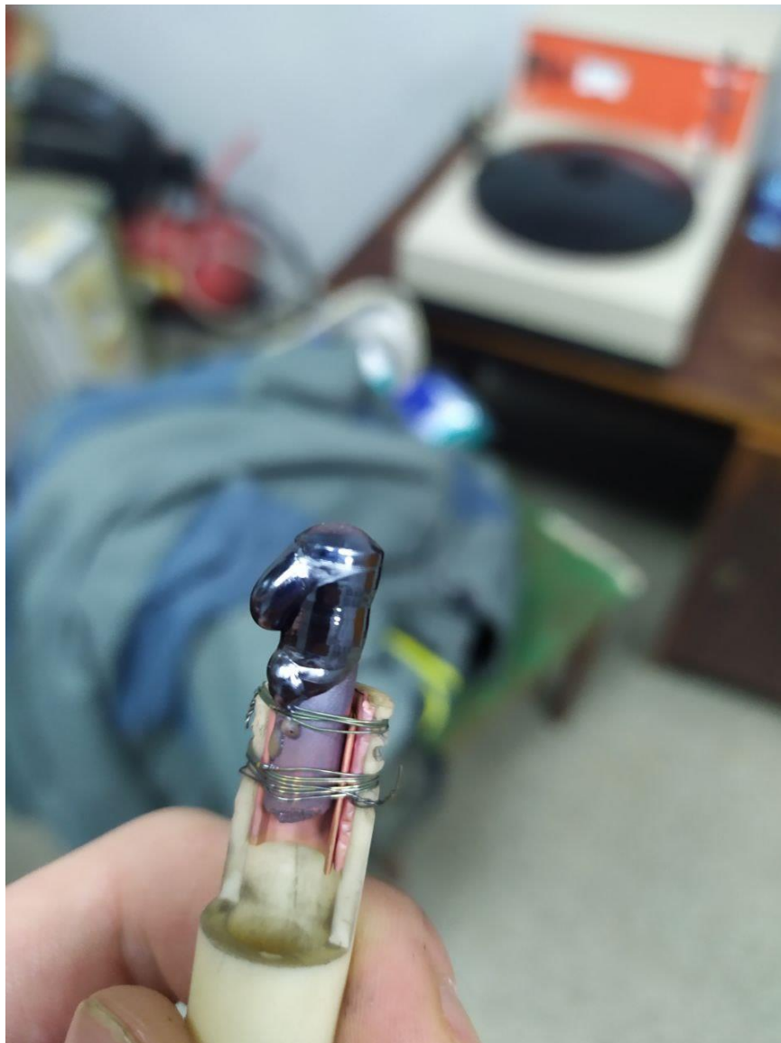
(рис.50 Неправильне розірвання зони з подальшим розливанням краплі)
