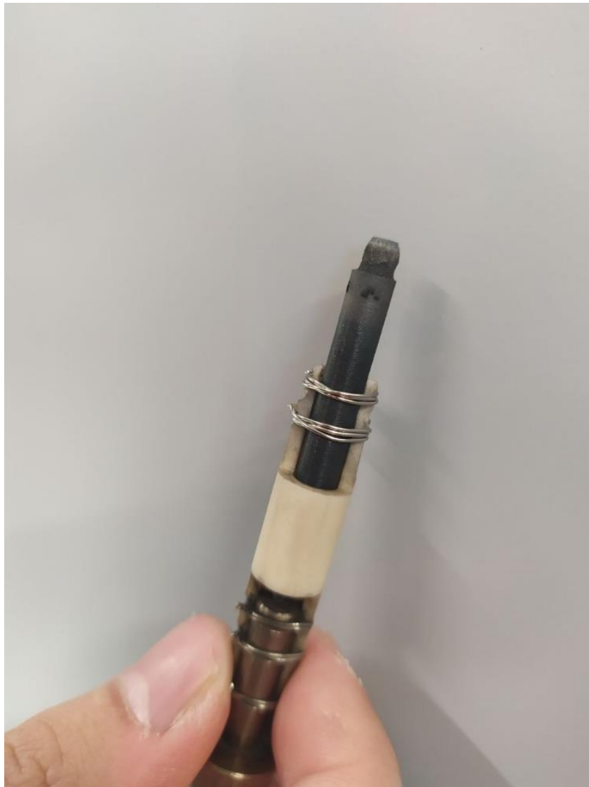
(рис.36 Результат приплавлення розчинника до фідроду)
