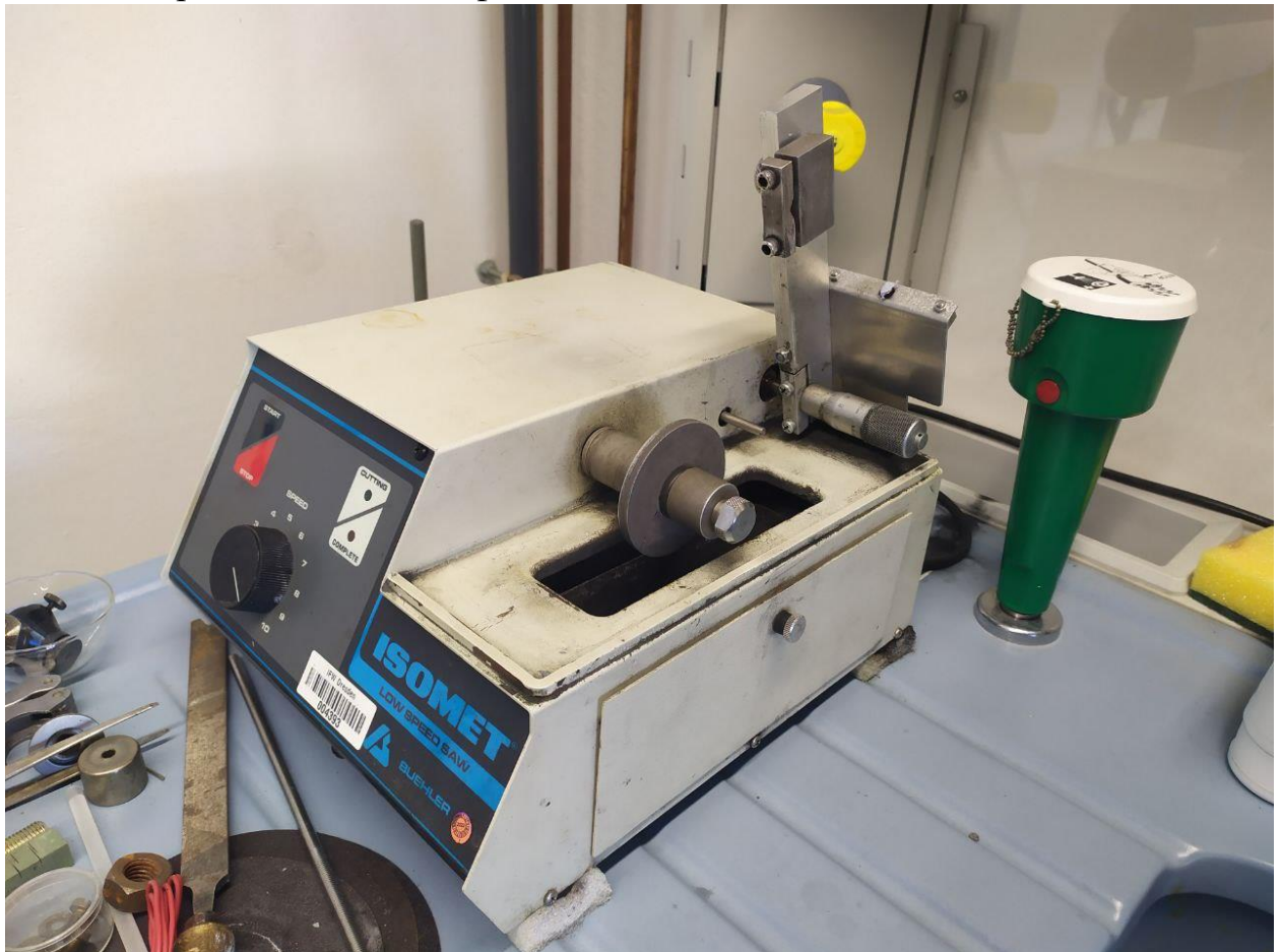
(рис.31 Різак зі спеціальним кронштейном для кріплення фіду або сіду)
