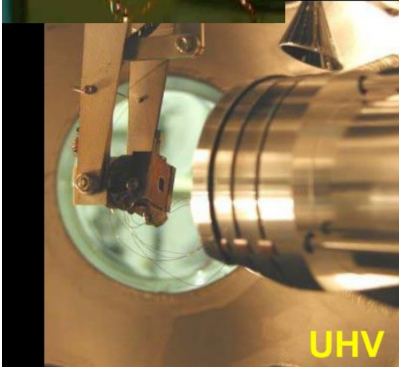
(рис.54 Маніпулятор для встановлення зразку всередину камери. Малюнок взято з [23])
