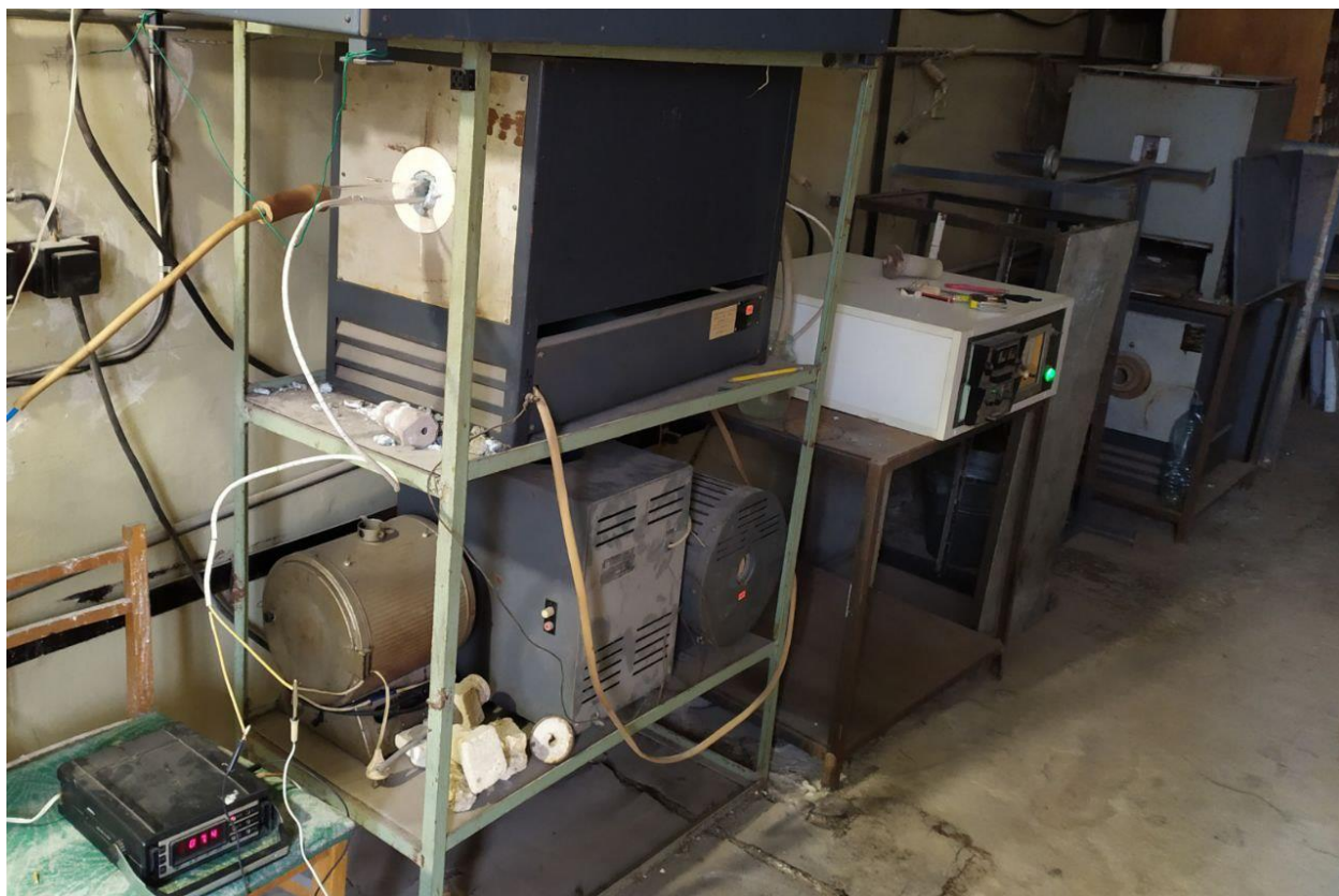
(рис.25 Муфельна піч горизонтального типу. Зразки поміщаються усередину пічки в тиглях, тобто є контакт поверхні тигля та роду)
