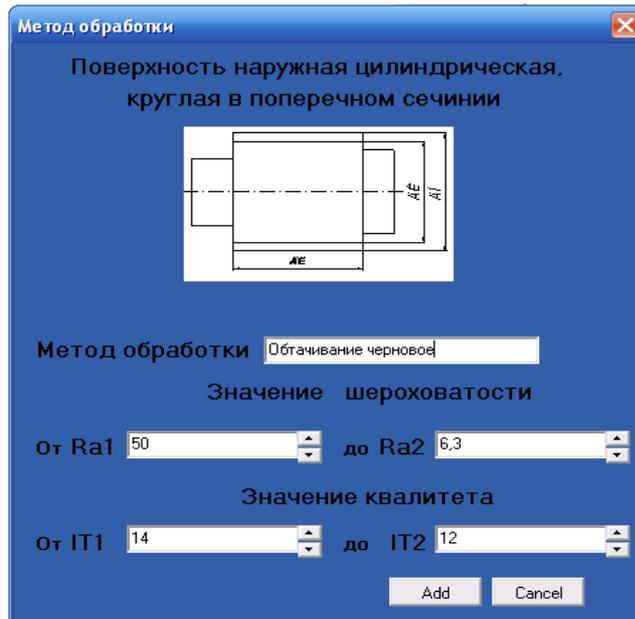
Рис. 4. Ввод данных о методах обработки поверхностей
