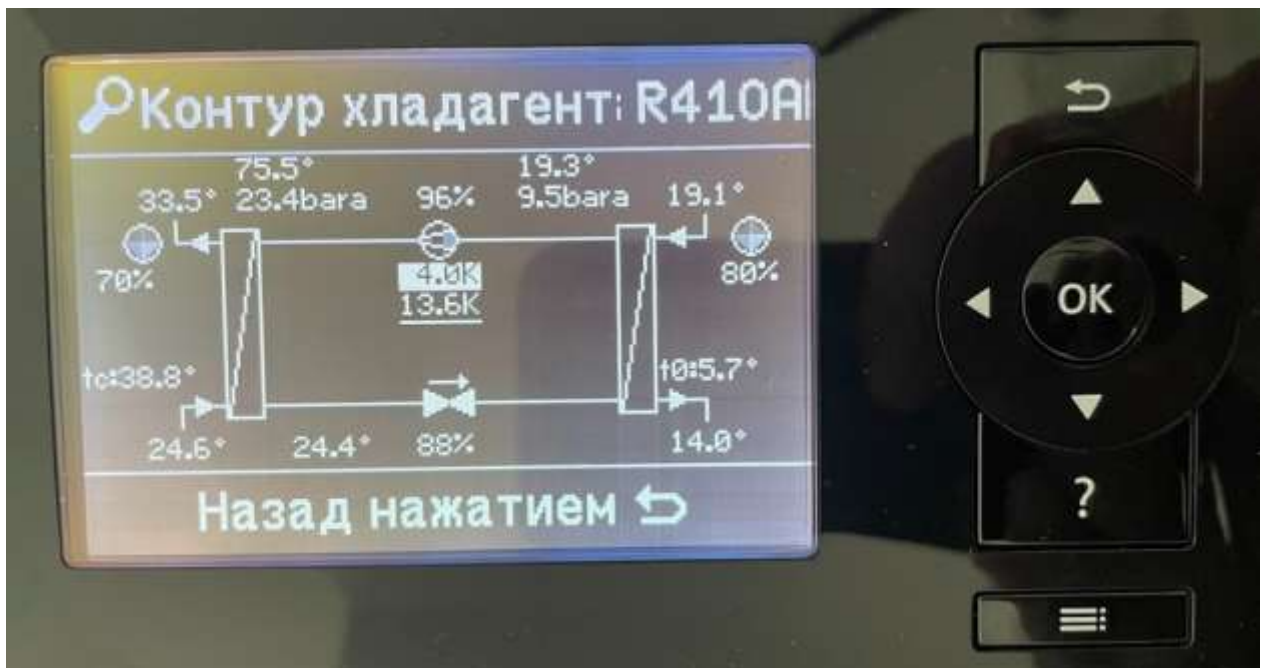
Рисунок 5. 13. Параметри фреону в холодильному контурі теплового насосу
