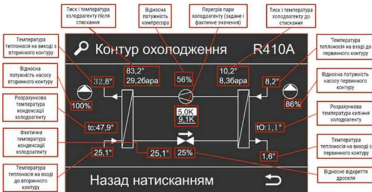
Рисунок 4.1. Інтерфейс блоку регулятора Vitotronic 200 WO1C.
