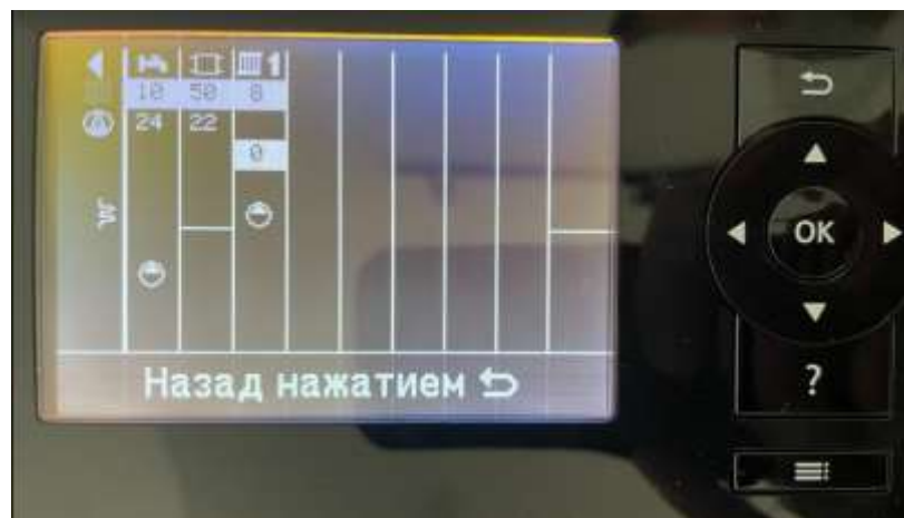
Рисунок 5.12. Інформація про температури води в буферній ємності
