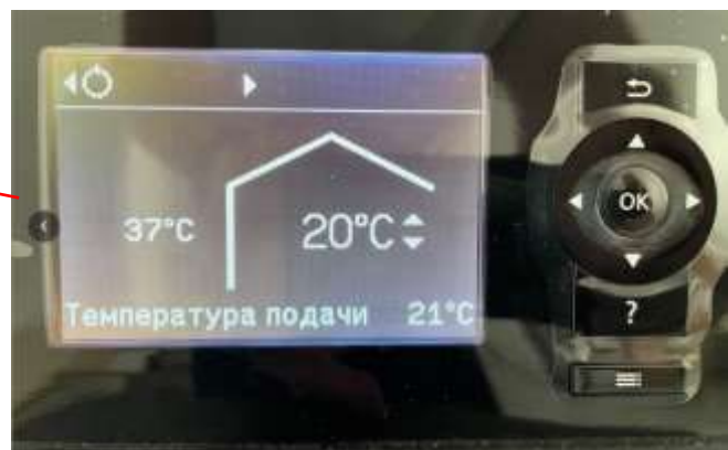
Рисунок 5.2. Регулятор теплового насосу на екрані в режимі «standby»
