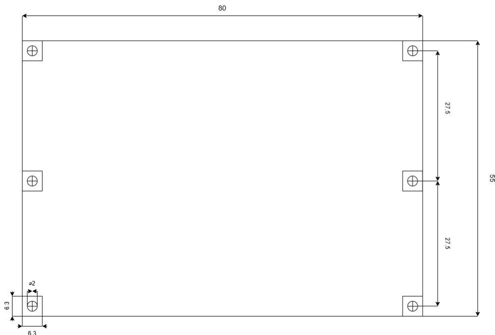
Рисунок 3.1 — Контур плати з місцями під кріплення
