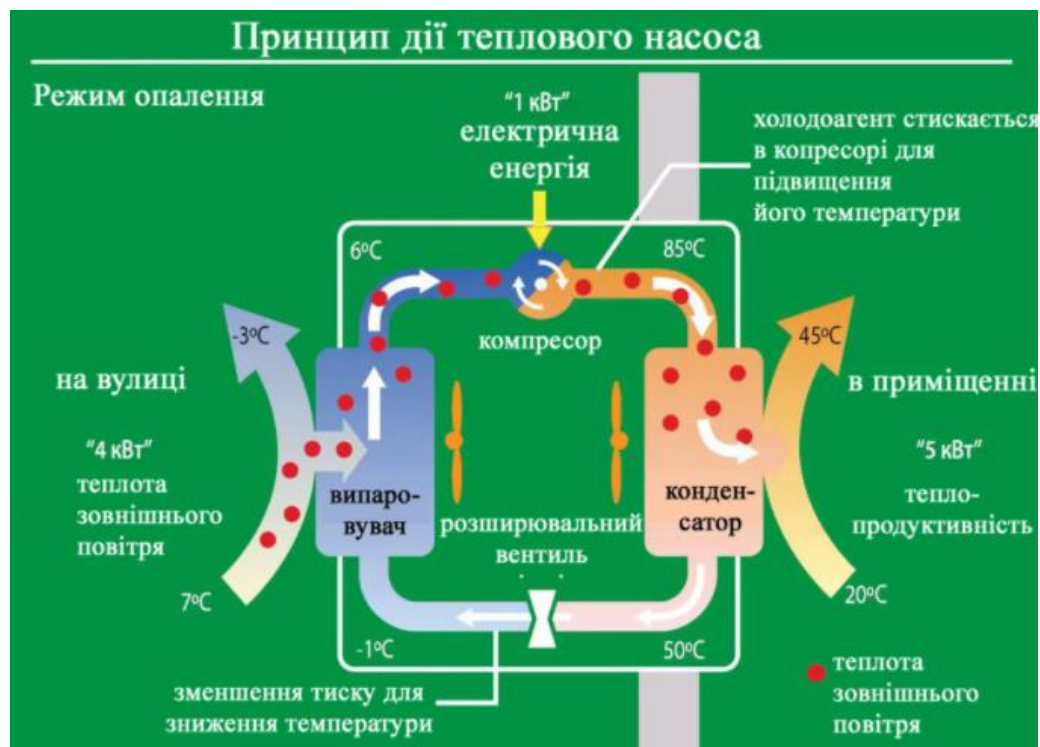
Рис. 7.6. Принцип дії теплового насосу [50]
