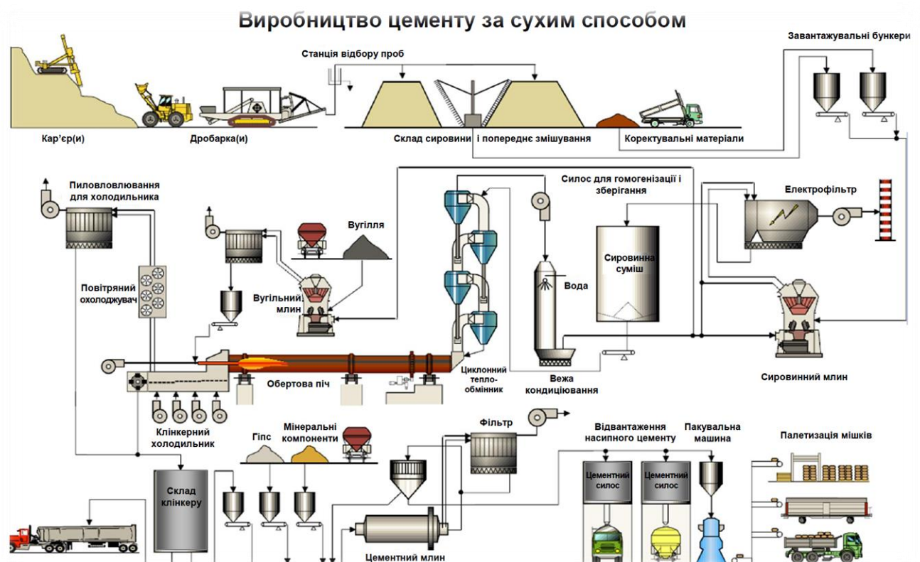
Рис. 4.4. Технологія виробництва цементу [31]
