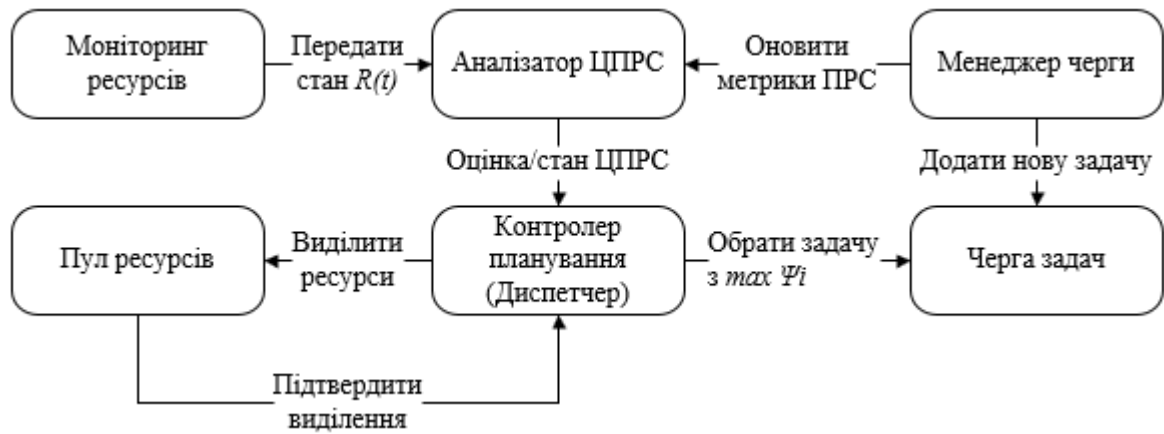
Рис. 3.2. Взаємодія компонентів гібридного планування кроків бізнес-процесів
