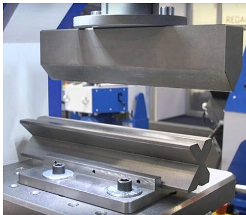
Рисунок 1.1 – Приклад універсального гідравлічного преса зі змінною оснасткою [37]
