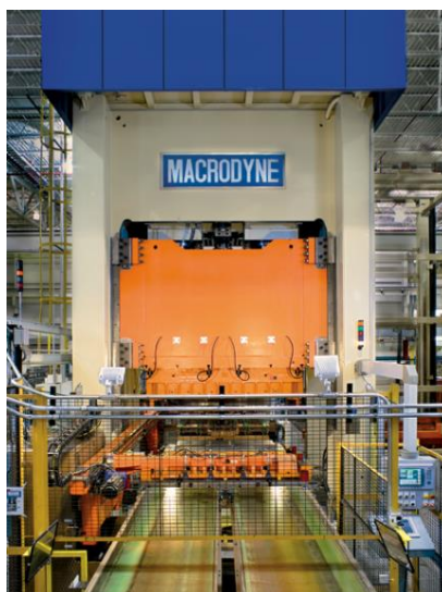
Рисунок 1.4 – Приклад автоматизованого гідравлічного пресового комплексу Macrodyne [17]
