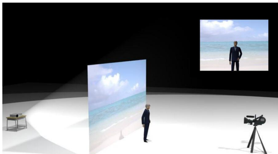
Рисунок 1.15 – Принцип роботи ріпроекції
