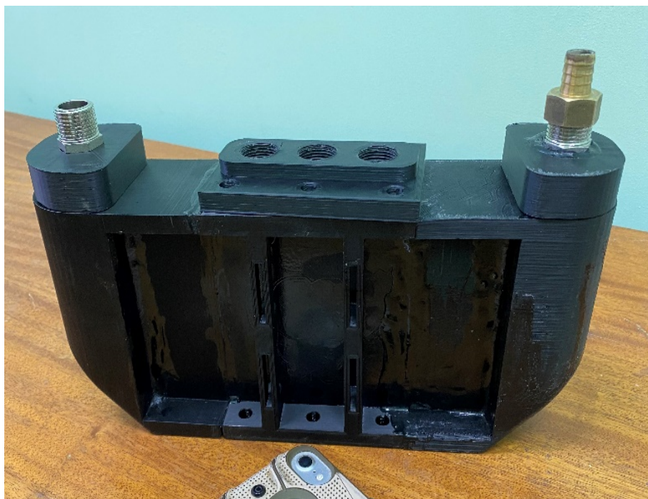
Рис. 2. Корпус прокачної кювети, виготовлений на 3D принтері та частково зібраний
