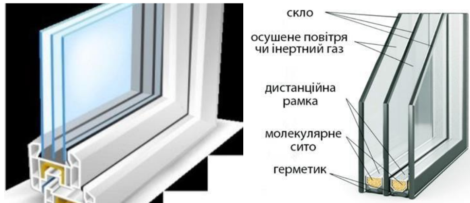
Рисунок 3.4 – Конструкція енергозберігаючих вікон, що пропонуються
