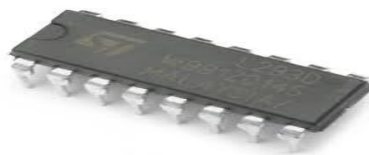
Рисунок 3.13 – Зовнішній вигляд мікросхеми L293D
